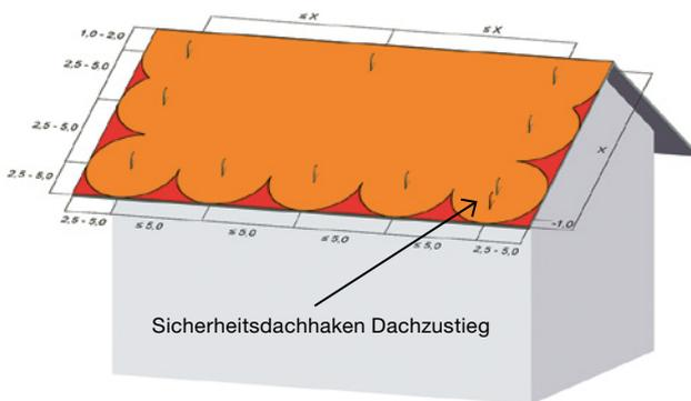
Anschlageinrichtungen auf geneigten Dächern, die nur aus Sicherheitsdachhaken ohne temporäre Lifeline bestehen, sind mit zusätzlichen Risiken verbunden, weil unter Umständen nicht alle Sicherheitsdachhaken bei gesicherter Arbeitsweise erreicht werden können.
