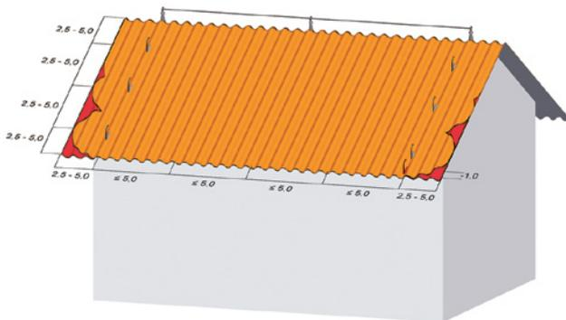
Anschlageinrichtungen mit horizontaler Führung, in Kombination mit Sicherheitsdachhaken
